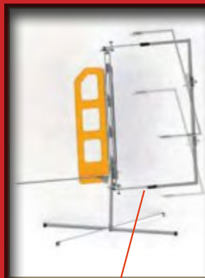
Prowadnica z łożyskiem wałeczkowym
