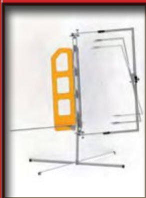
Wysuwany i odwracalny wspornik tnący
